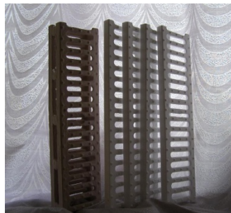
Рис. 8. Решетки ливнеприемников и канализационных систем, которые льют в стопках
